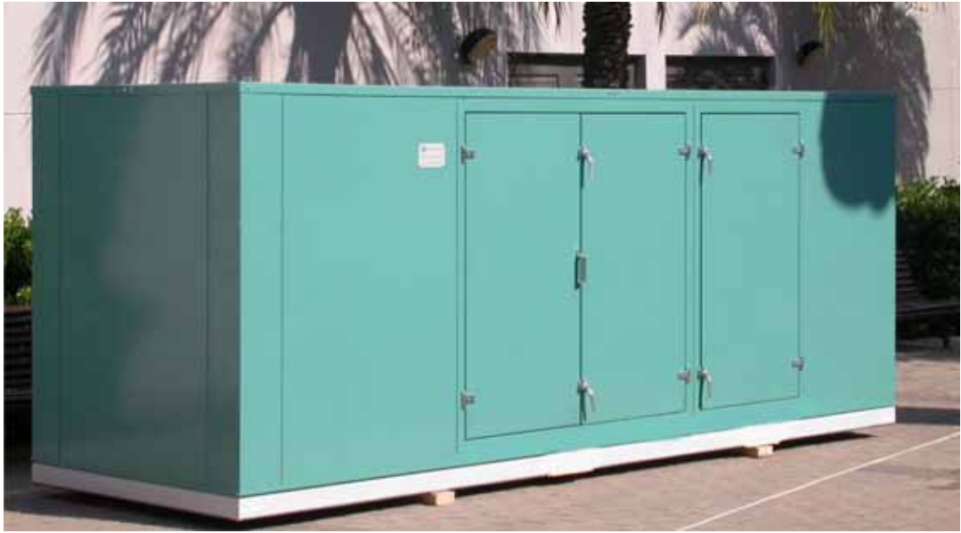
Módulo de microgeneración insonorizado de 60 KW previo a su instalación en una Piscina climatizada. (El Prat de Llobregat – Barcelona – España)
